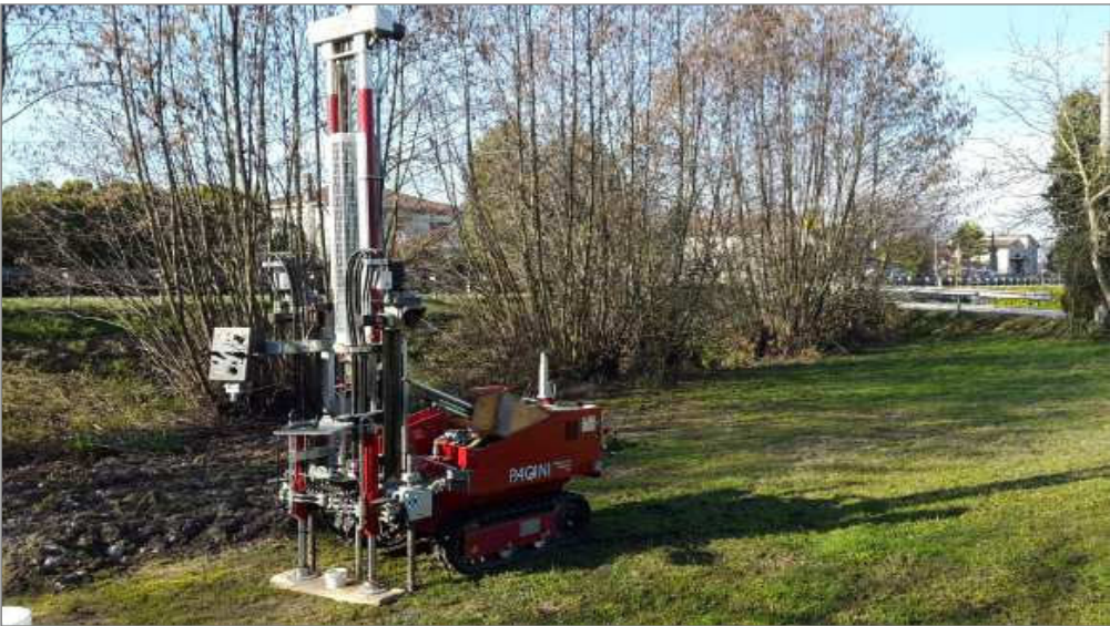
Immagine della fase di approntamento della Prova Penetrometrica Statica
