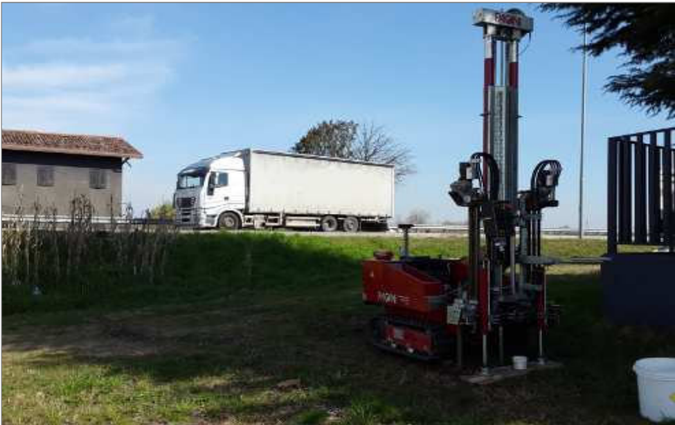
Immagine della fase di approntamento della Prova Penetrometrica Statica
