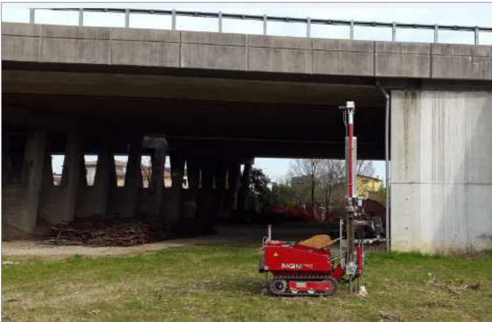
Immagine della fase di approntamento della Prova Penetrometrica Statica
